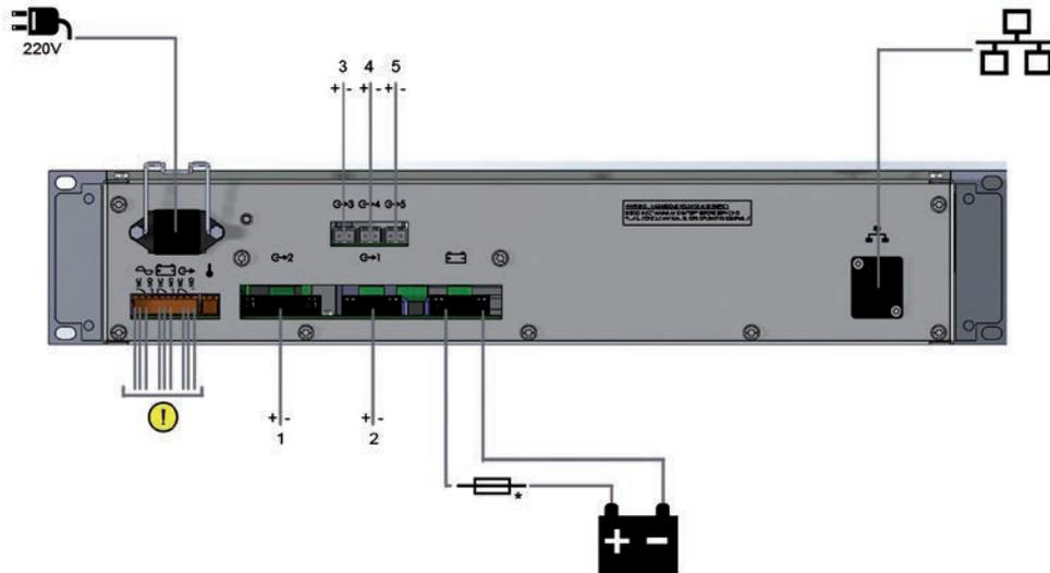
\*Sicherung nicht mitgeliefert. Sie muss entsprechend des maximalen Betriebsstroms der Anlage kalibriert werden.
