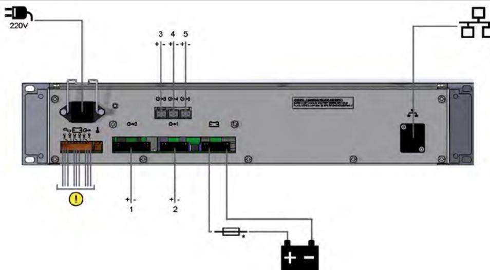
\*Fusible non fourni, à calibrer en fonction du I utilisation maxi de l'installation.
